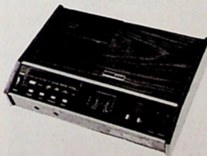
Afb. 3. Cassette-magnefoon van HARMANN-KARDON met ingebouwd DOLBY-systeem. Door gebruik te maken van AGFA-chroomdioxideband is deze cassette-magnefoon de eerste die met een snelheid van 4,75 cm/s binnen de DIN 45.500 valt.
